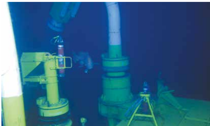
Figure 3. Transpondeurs inclus dans la photogrammétrie
