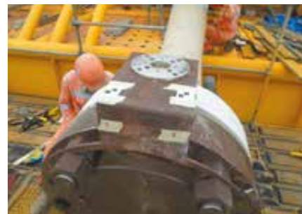
Figure 2. Une bride de son interface de métrologie
