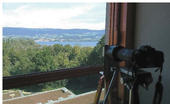
Figure 5. Le second dispositif expérimental, montrant l'appareil photographique avec son objectif de 600 mm de focale, ainsi que le support des filtres placé immédiatement devant, sans contact.
