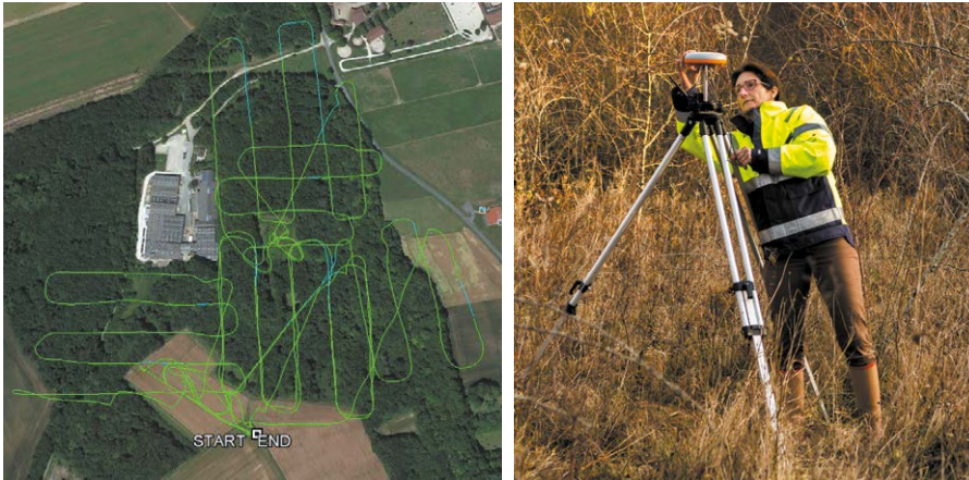
Figure 6. Tracé des vols et installation de la balise RTK sol
