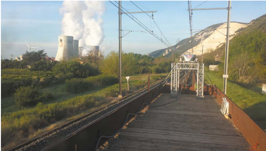
Scanner laser dynamique Riegl VMX-450 - Campagne de mesure TEPE - 2014
