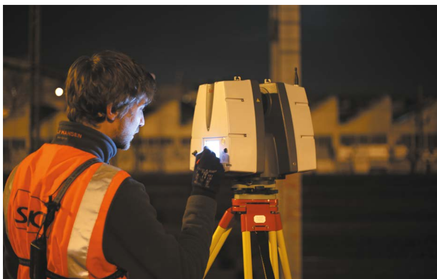
Relevé de nuit par scanner laser statique (Leica P40) - Gare de Paris Nord - 2016
