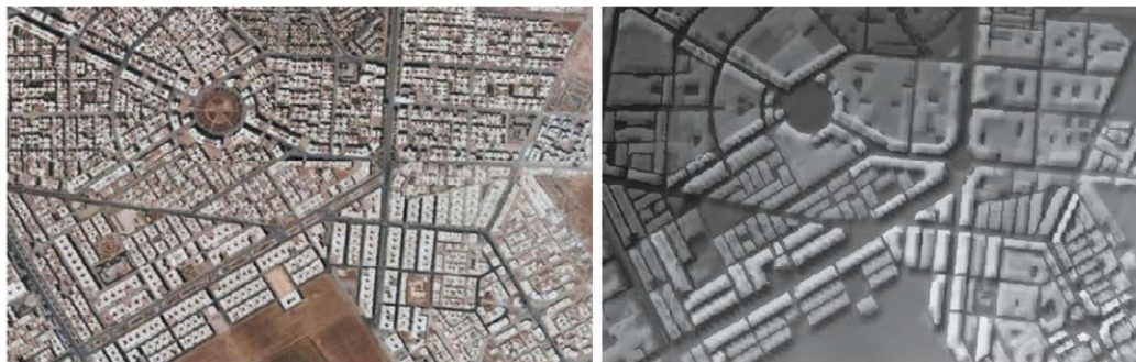
Figure 8. Orthophoto (à gauche) et MNS généré à partir de photographies aériennes (à droite).
