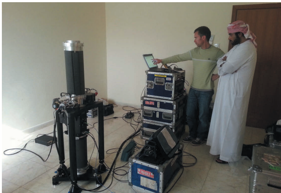
Figure 9. Mesure avec le gravimètre absolu FG-5 (Micro-g Lacoste) lors d'une campagne de mesures aux Émirats Arabes Unis (Fugro et Université de Montpellier, 2016)
