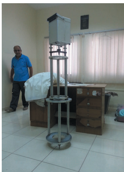
Figure 10. Mesure du gradient vertical avec gravimètre CG-5 Scintrex monté sur trépied lors d'une campagne de mesures aux Émirats Arabes Unis (Fugro, 2016)
