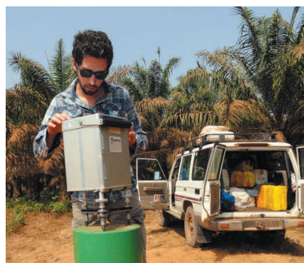
Figure 11. Mesures gravimétriques terrestres avec CG-5 Scintrex lors d'une campagne en Guinée (Fugro, 2013)
