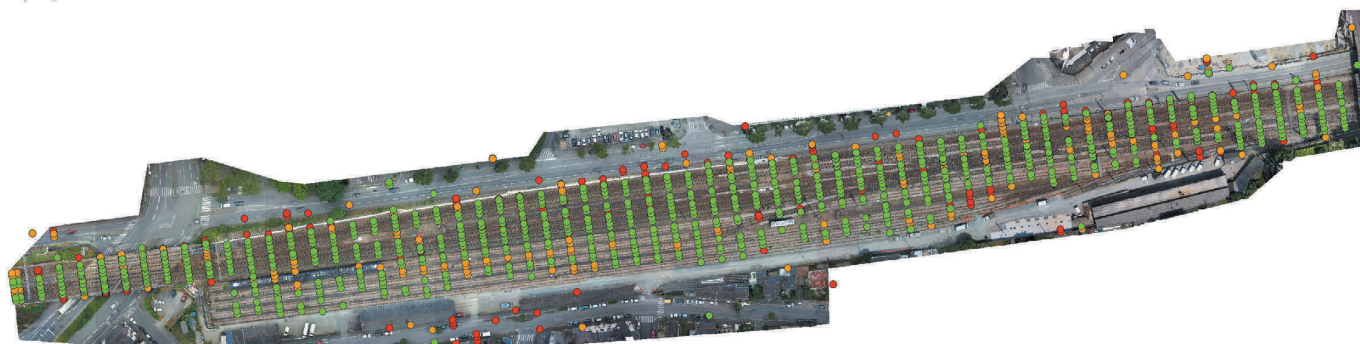
Figure 13. Superposition du nuage de points extrait avec l'orthophoto
