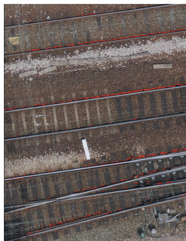
Figure 8. Détection des zones d'ombres (en rouge) (sans échelle)
