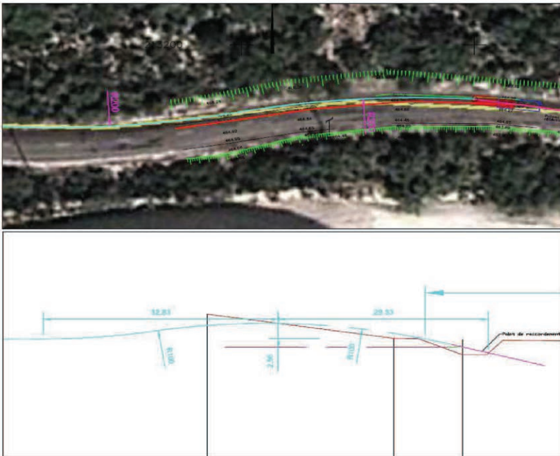
Figure 4. La déformée de la canalisation sur la rampe de lancement.
