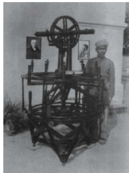
Figure 4. Le grand théodolite de Cary. Son cercle horizontal a 36 pouces (91 cm) de diamètre et son cercle vertical 18 pouces. L'instrument avec sa boîte de transport pesait 500 kg. Remarquer au fond à gauche le portrait de Lambton, reproduit ici Fig. 1. D'après Fillimore, vol. 4.
