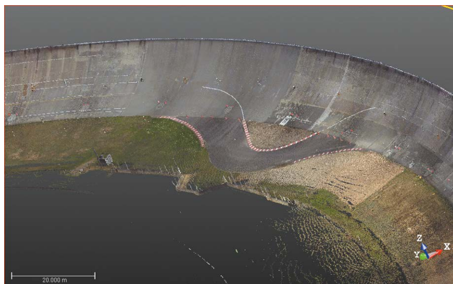
Figure 9. Nuage de points échantillonné à 2 cm
