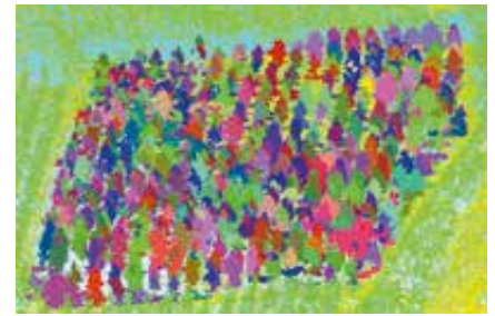
Figure 20. Individualisation d'arbres à partir du nuage de points LiDAR
