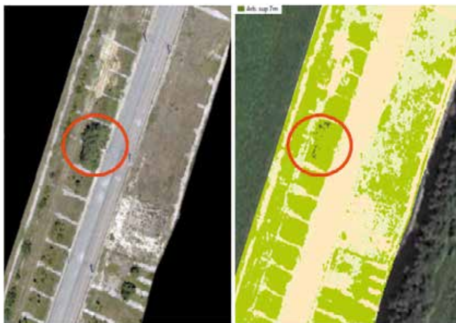
Figure 24. Défaut de corrélation dans les images drone
