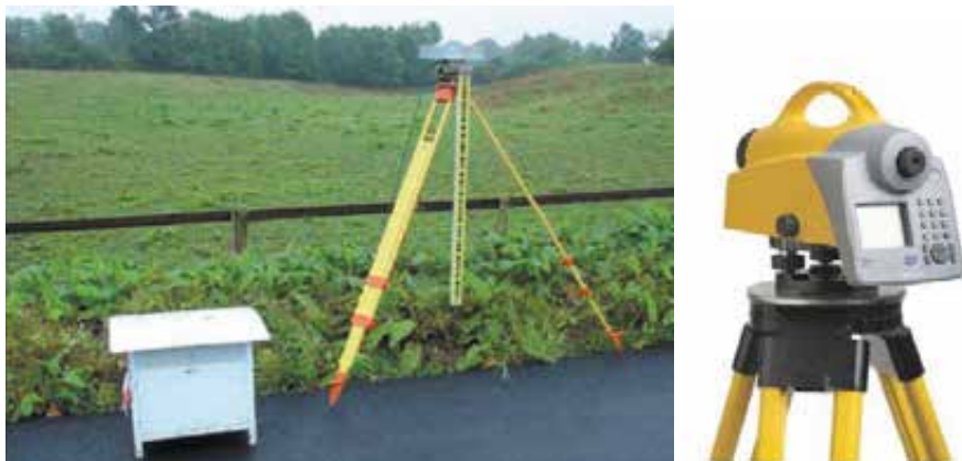
Figure 5. Matériel utilisé pour les observations ERNIT : antenne GNSS équipée d'une mire code-barres et niveau TRIMBLE DINI
