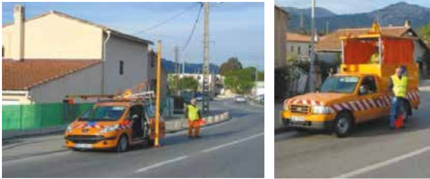
Figure 16. NIREF : nivellement de précision motorisé
