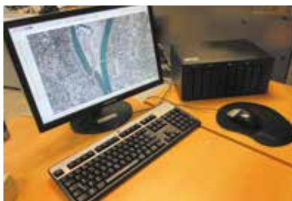
Serveur NAS avec 10 To d'espace disque
