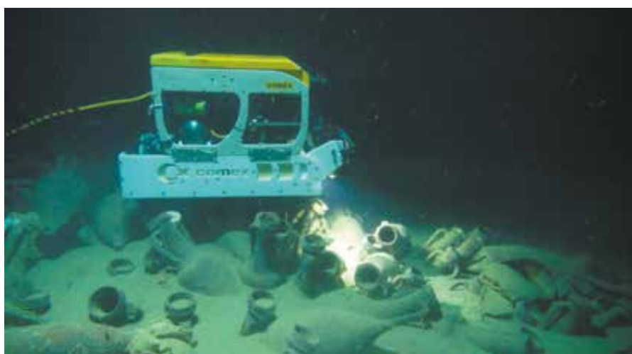
Figure 1. Le ROV Apache, équipé du système de photogrammétrie, pendant la phase d'acquisition sur l'épave Cap Bénat 4 à 328 mètres de profondeur. Prise de vue réalisée depuis le ROV Super Achille.
