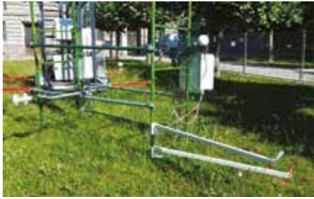
De gauche à droite : Figure 6. Mesure de la transpiration de la pelouse par la méthode du rapport de Bowen - Figure 7. Capteurs de mesure du PAR, du taux d'humidité et de température de la couronne - Figure 8. Mat déployé sur 20 mètres pour mesure des paramètres climatiques et de la turbulence - Figure 9. Radio-thermomètres mesurant la température de brillance
