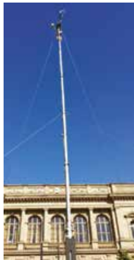
De gauche à droite : Figure 6. Mesure de la transpiration de la pelouse par la méthode du rapport de Bowen - Figure 7. Capteurs de mesure du PAR, du taux d'humidité et de température de la couronne - Figure 8. Mat déployé sur 20 mètres pour mesure des paramètres climatiques et de la turbulence - Figure 9. Radio-thermomètres mesurant la température de brillance
