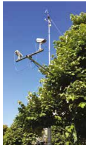
De gauche à droite : Figure 6. Mesure de la transpiration de la pelouse par la méthode du rapport de Bowen - Figure 7. Capteurs de mesure du PAR, du taux d'humidité et de température de la couronne - Figure 8. Mat déployé sur 20 mètres pour mesure des paramètres climatiques et de la turbulence - Figure 9. Radio-thermomètres mesurant la température de brillance
