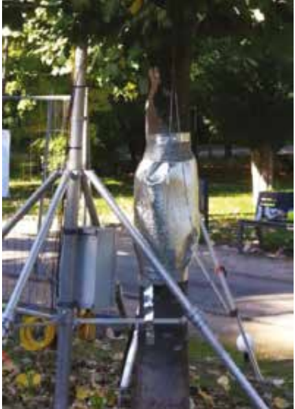
Figure 4. Capteur de flux de sève, protégé par une enveloppe en aluminium
