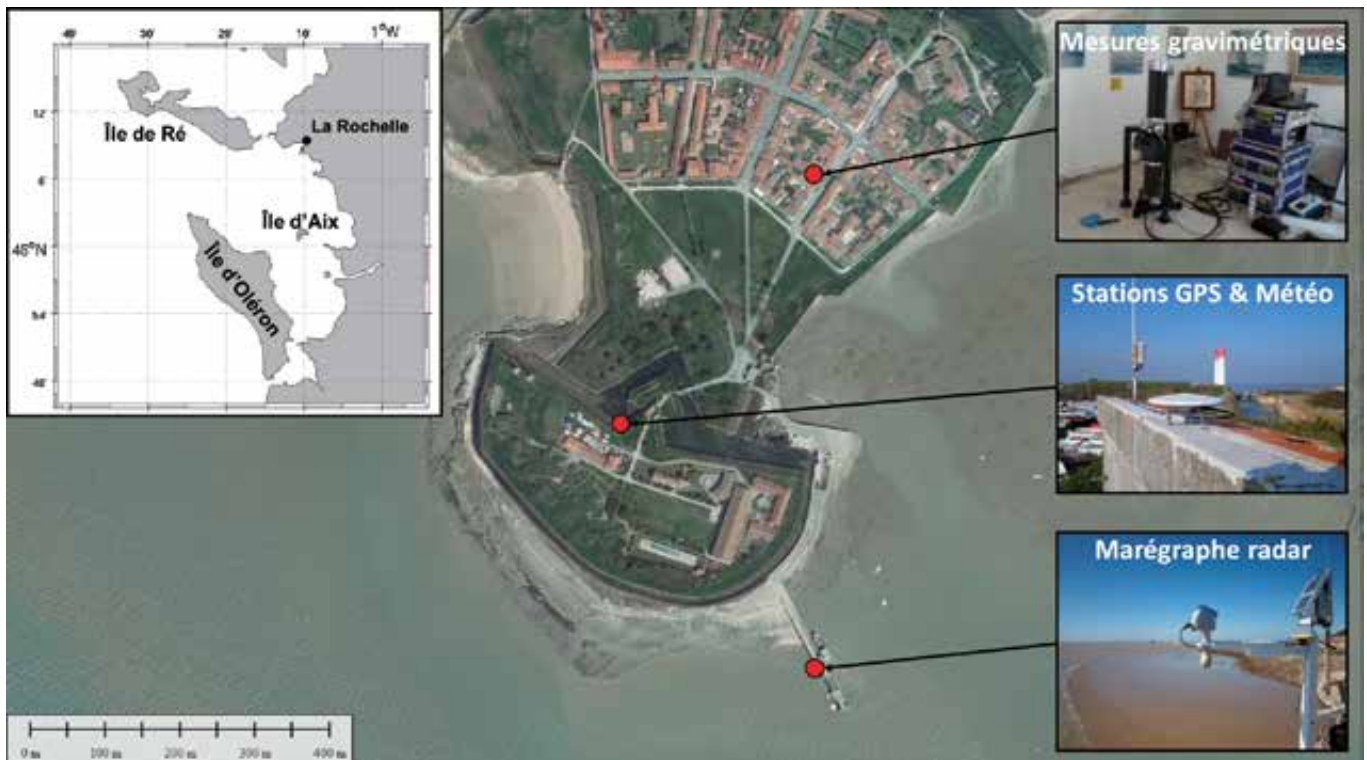
Figure 1. Observatoire du niveau de la mer de l'île d'Aix. Cet observatoire comprend un marégraphe radar, une station météorologique et une station GPS.
