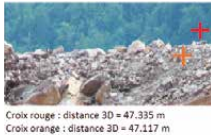
Figure 6. Problème d'extrapolation évité grâce à l'analyse directionnelle
