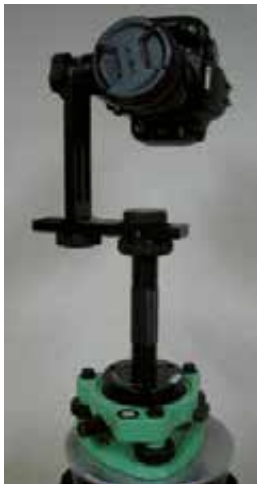
Figure 8. Rotule panoramique couplée à un appareil photo numérique [Leica Geosystems]
