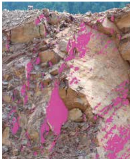
Figure 13. Recherche de l'orientation N 228°/82°, écart 14° (Direction de l'horizontale/Pendage)
