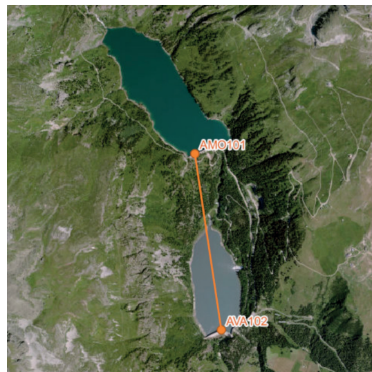
Figure 3. Visée réciproque entre les barrages de Plan d'Amont et de Plan d'Aval.
