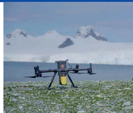
Figure 4. Le LiDAR YellowScan Mapper incluant un module caméra, embarqué sur un M300 de chez DJI.
