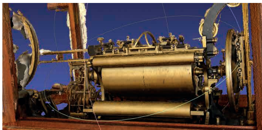
Figure 7. Premier modèle 3D du mécanisme du marégraphe.
