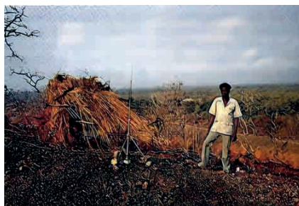
Photo 1. Récepteur Doppler en station dans la savane africaine (Carrère et al., 1987).
