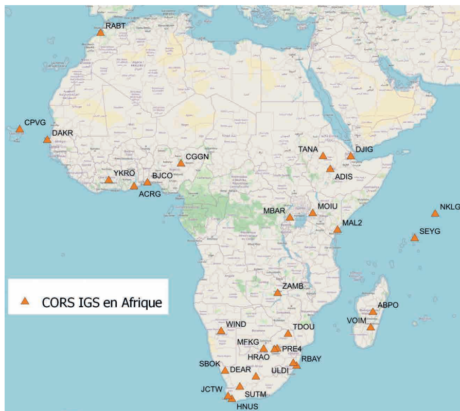
Figure 9. Répartition spatiale des stations GNSS permanentes (SGP) de l'IGS en 2022 pouvant constituer la base du réseau AFREF.
