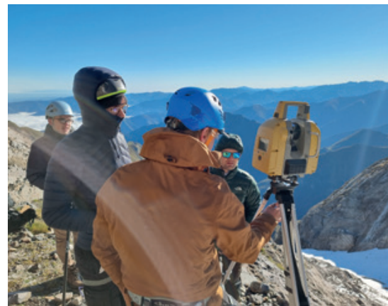
Figure 5. Mesurages au scanner laser 3D du glacier et de la moraine.
