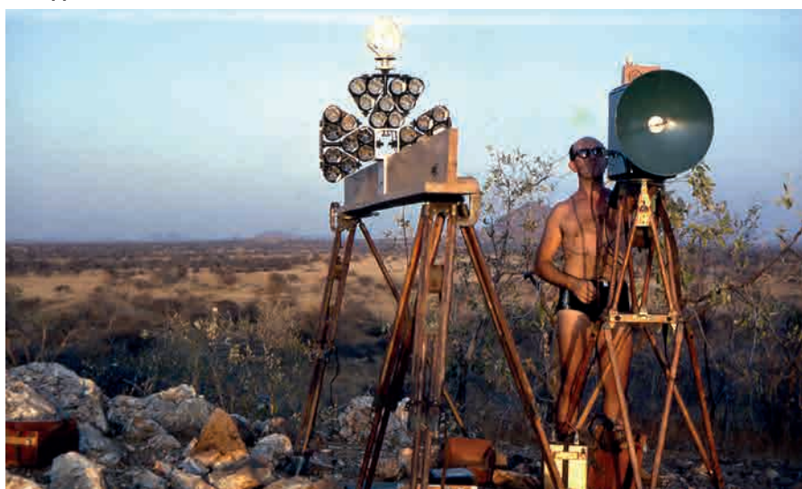
La planche de 2,50 m avec les 27 prismes et le projecteur puis le telluromètre "répondeur".
