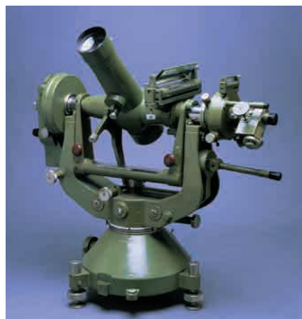
T4 de l'ancienne galerie IGN Doc. IGN : T4 sur son trépied lesté et gros plan sur la nivelle.
