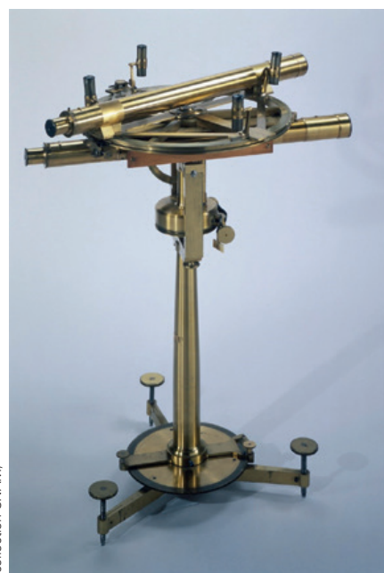
Figure 5. Cercle répétiteur de Borda (collection CNAM). Cet instrument de mesure angulaire permet, en répétant plusieurs fois la même observation sans revenir au zéro, de diviser les erreurs de lecture et de graduation par le nombre d'observations.
