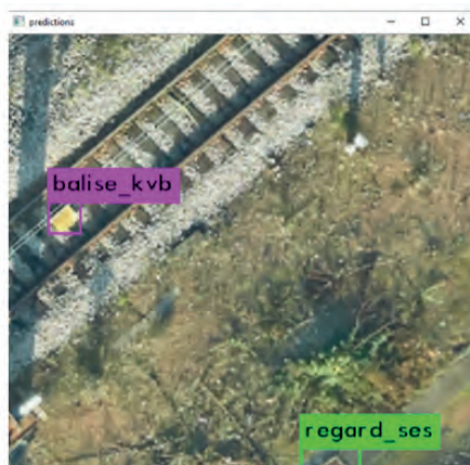
(a) - Détection d'une balise KVB et d'un regard SES tronqué avec des taux de confiance de 100%
