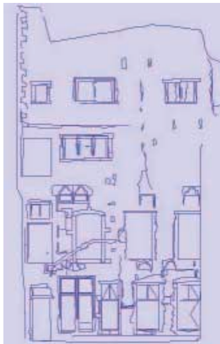
(b) relevé topographique de la façade. Les points et les distances de contrôle sont utilisés pour le redressement des photos
