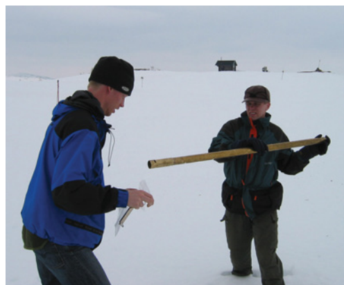
Mesures de contrôle par GPS-RTK et sonde, ainsi que par carottage.
