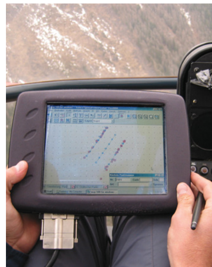
Lignes de vol avec les points mesurés précédemment au sol et indication en temps réel de la position de l'hélicoptère (radar monté à la verticale de l'antenne GPS)
