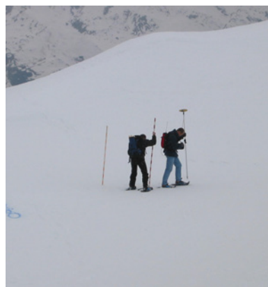
Mesures de contrôle par GPS-RTK et sonde, ainsi que par carottage.
