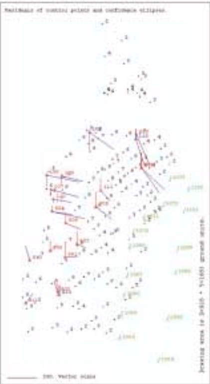
Figure 8 : vecteurs résidus sur les points de contrôle (check point) pour l'orientation sans point d'ajustage.
