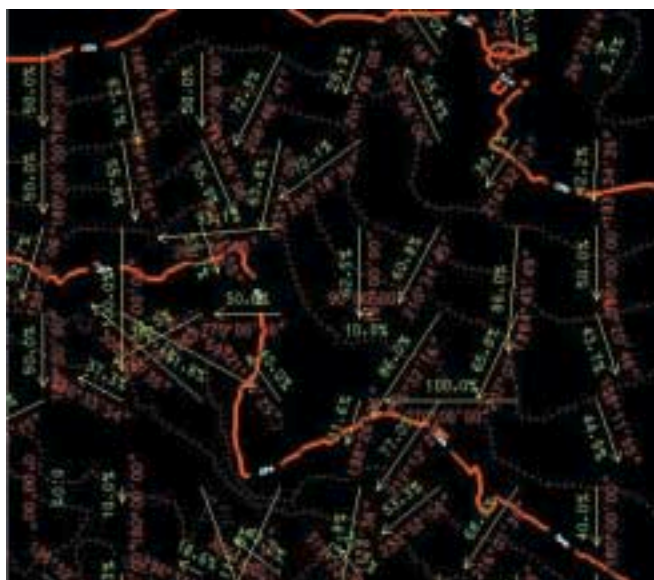
Reconstitution de la matrice des pentes avec direction, intensité superficies de chaque maille, ce qui permet de simuler la génération des débits sur un bassin versant..
