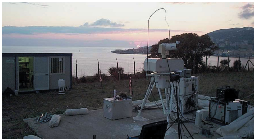
Figure 2 : Station de télémétrie laser ultra-mobile (FTLRS) installée sur la base d'Aspretto (Ajaccio, Corse)
