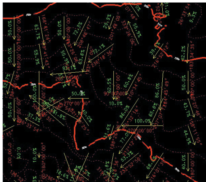
Reconstitution de la matrice des pentes avec direction, intensité superficielles de chaque maille, ce qui permet de simuler la génération des débits sur un bassin versant..
