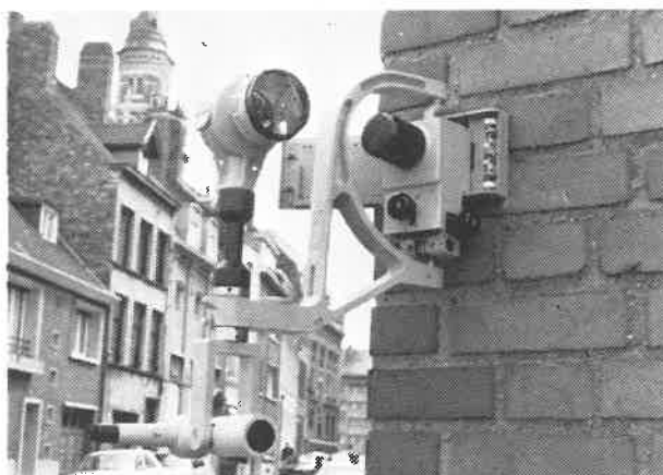
Repère ouvert avec accessoire pour tachéomètre électronique.
