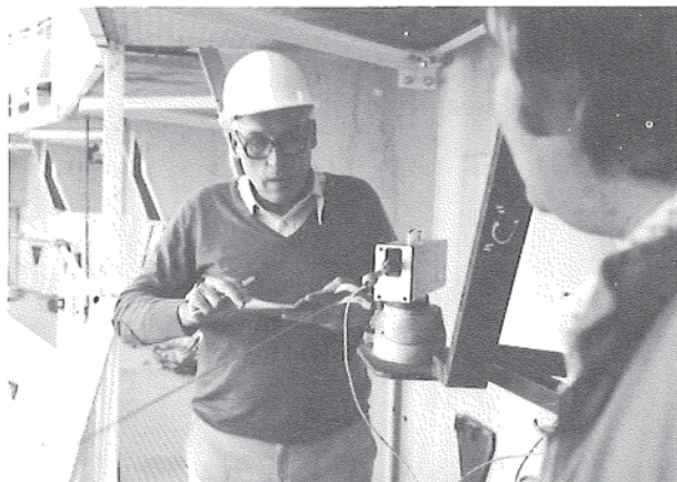
Chaudière nucléaire. Micro-canevas interne au bâtiment réacteur. Mesure de base avec distivar pour chemin de roulement du pont polaire.
