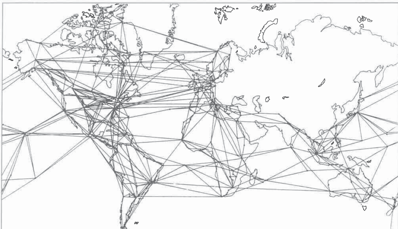
Fig. 4 – Liaisons au gravimètre utilisées dans le réseau IGSN 1971
