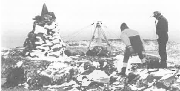
Mesures GPS aux Kerguelen sur le site baptisé «Table du Telluromètre». On peut considérer que la précision obtenue avec le GPS rend caduc la plupart des levés français antérieurs à 1970. (photo Epsom)
