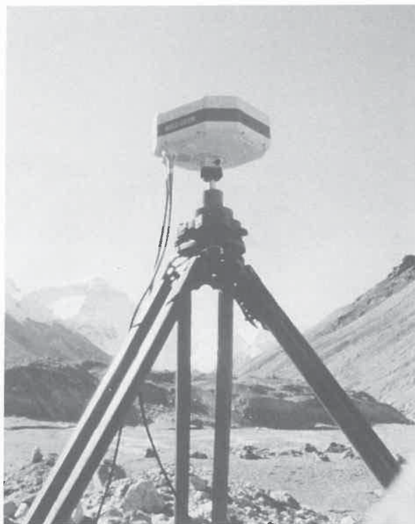
Capteur SR 299 du système Wild GPS 200, dans la vallée glacière de Rongbuk. Au fond le Mont Everest (Photo CPDC/Leica).
