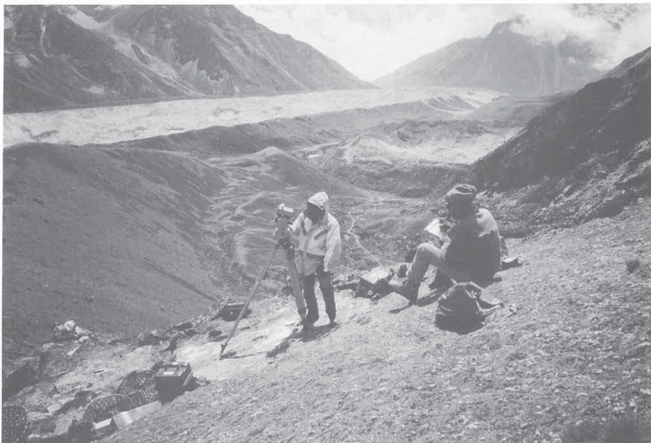
Albert Beinat au-dessous du glacier Khumbu (5 300 m), et son équipement topographique comprenant le théodolite de précision WILD T 3000 et le distancemètre WILD DI 3000 (Photo UT/Leica).
