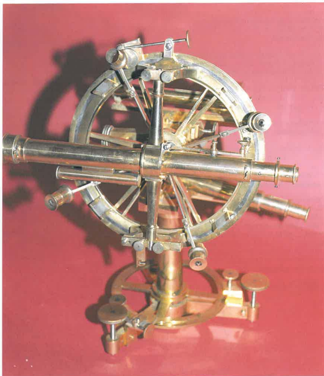
Cercle de Gambey qui servit à la mensuration du méridien terrestre et portant sur son piétement l'indication "Dépôt de la guerre" n° 9 - 1823"
