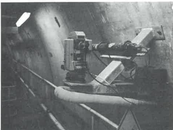
Les théodolites Wild dotés d'un oculaire laser sont utilisés en combinaison avec les distancemètres Wild.
