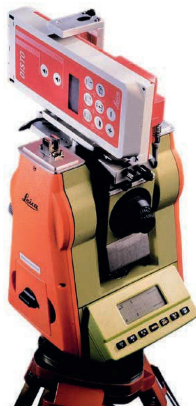
Figure 4. Le Leica DISTO, monté sur la lunette d'un tachéomètre électronique, permet les premières mesures de distance sans prisme.
