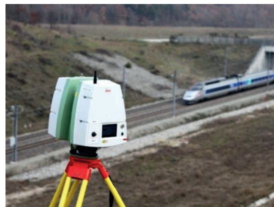
Figure 11. Le Leica C10 en opération pour le suivi d'un versant
