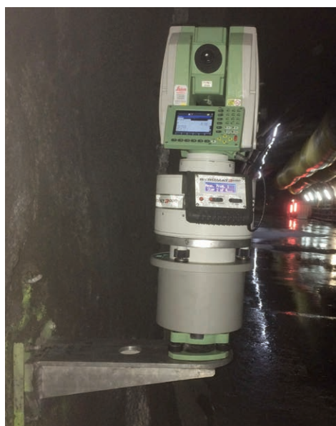
Figure 9. Gyromat 3000 sur console (à gauche) et sur pilier (à droite)
