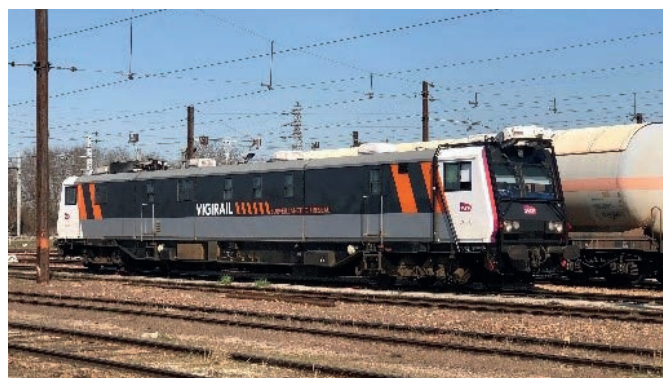
Figure 14. Un Engin de Surveillance de la Voie (ESV) équipé du système LiDAR RIEGL New VMX-Rail
