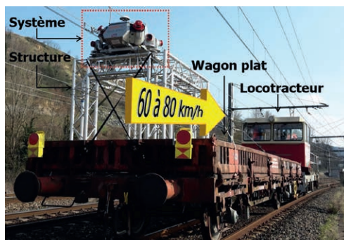
Figure 12. Le système Riegl VMX-450
