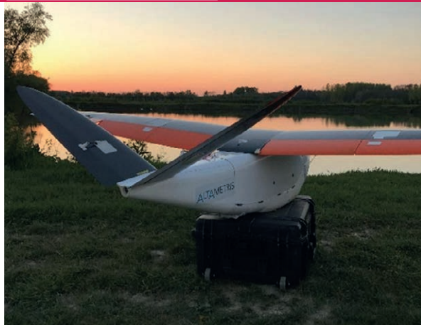
Figure 17. Le système Delair DT26 déployé pour les missions de détection d'intrusion sur le réseau
