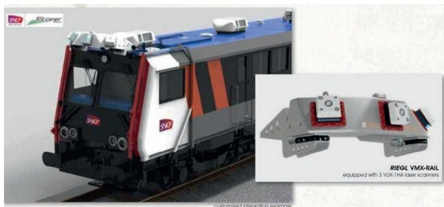
Figure 14. Un Engin de Surveillance de la Voie (ESV) équipé du système LiDAR RIEGL New VMX-Rail
