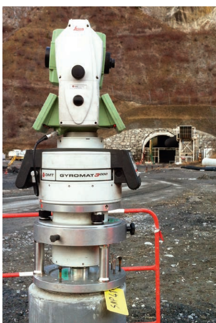
Figure 9. Gyromat 3000 sur console (à gauche) et sur pilier (à droite)
