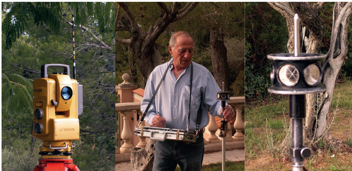
Figure 5. Une station motorisée Topcon A8-L1A de 1999 qui suit automatiquement le prisme en mouvement. L'antenne permet la liaison avec l'opérateur qui peut dessiner en temps réel son lever en DAO.
