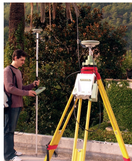
Figure 10. Le GPS en temps réel acquis par mon successeur vers 2003. Quand la liaison radio fonctionne, c'est extraordinaire !
