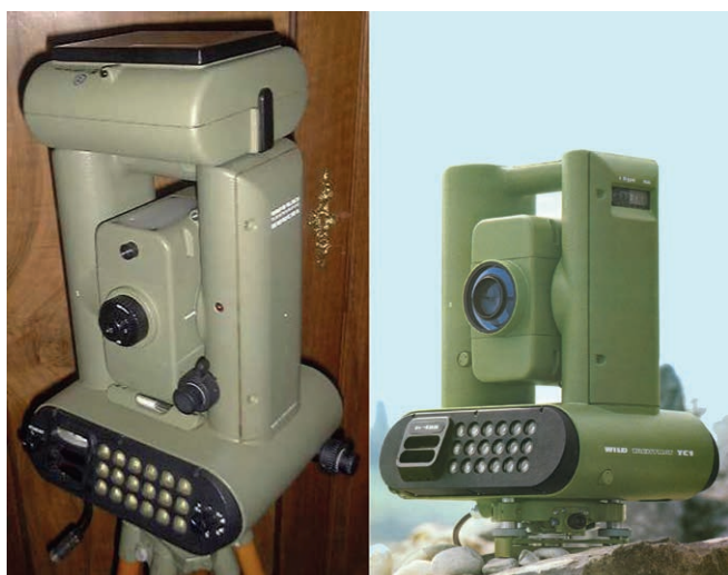
Figure 3. La première station totale de Wild, la TC1 lancée en 1978. Un modèle enregistrait les mesures sur un volumineux coffret extérieur, sur l'autre modèle, elles devaient être notées à la main.
