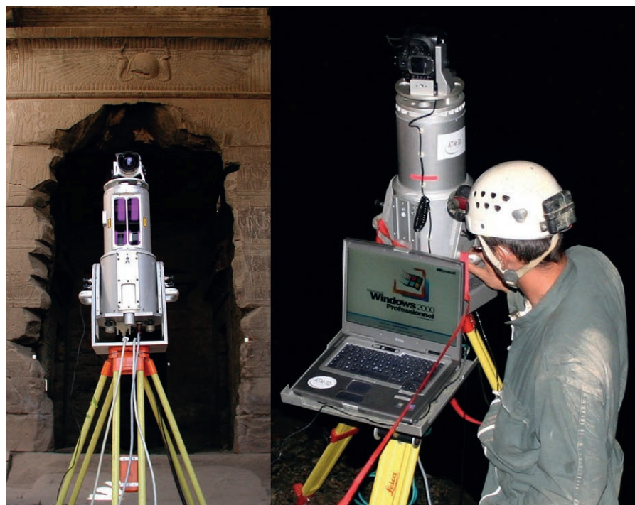
Figure 7. Ici à Karnak et au gouffre de la Pierre Saint-Martin, les scanners laser Riegl Z390 et Z410, avec caméra Nikon pour mieux adapter le semis de points à l'image.
