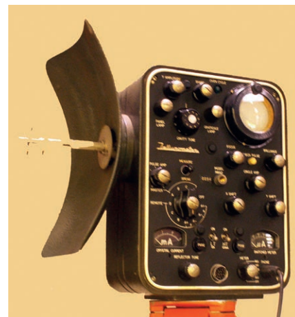
Figure 1. Le Telluromètre MRA2 : ici le maître qui émet vers le répondeur une onde qui lui sera renvoyée. Sans LED la mesure sera donnée par la coupure d'un cercle sur le petit écran cathodique.
