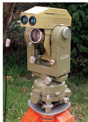
Figure 4. Le distancemètre DI 1000 apparu plus tard pouvait être monté sur la station TC 1000 et sur l'ancien T2, un câble permettait d'enregistrer les mesures.
