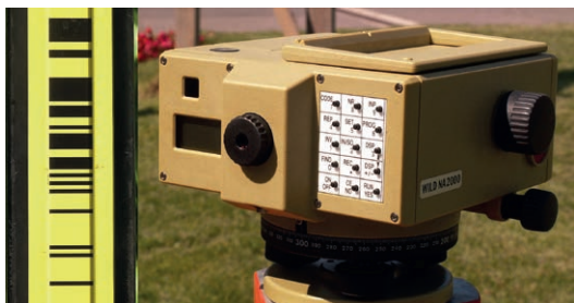
Figure 6. Le Leica NA2000 et sa mire code-barres, premier niveau numérique apparu sur le marché.
