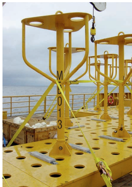
Figure 11. Support permanent pour transpondeur acoustique, mise en place du transpondeur par ROV
