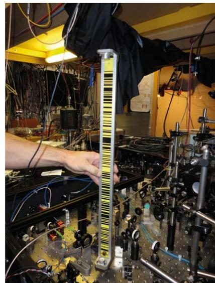
Figure 2. Nivellement d'une table d'horloge, campagne de 2013.
