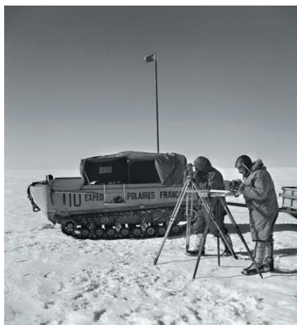
Photo 6. Grisoni et Riquer au travail, le premier avec un théodolite Wild T2, le second avec un miroir, sur l'inlandsis, à plus de 2000 m d'altitude, le 21 juillet.
