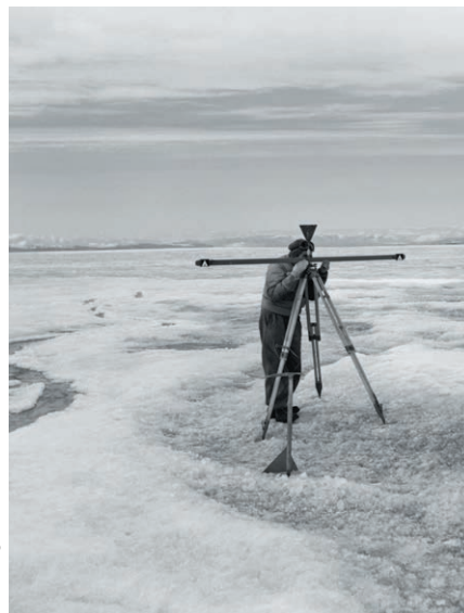
Photo 8. Mise en station de la stadia invar Wild équipée d'une mirette additionnelle centrée, au Camp IV, le 3 août. Au premier plan, le névé travaillé par la fonte. Au fond, la ligne sombre des nunataks, montagnes de la région côtière.
