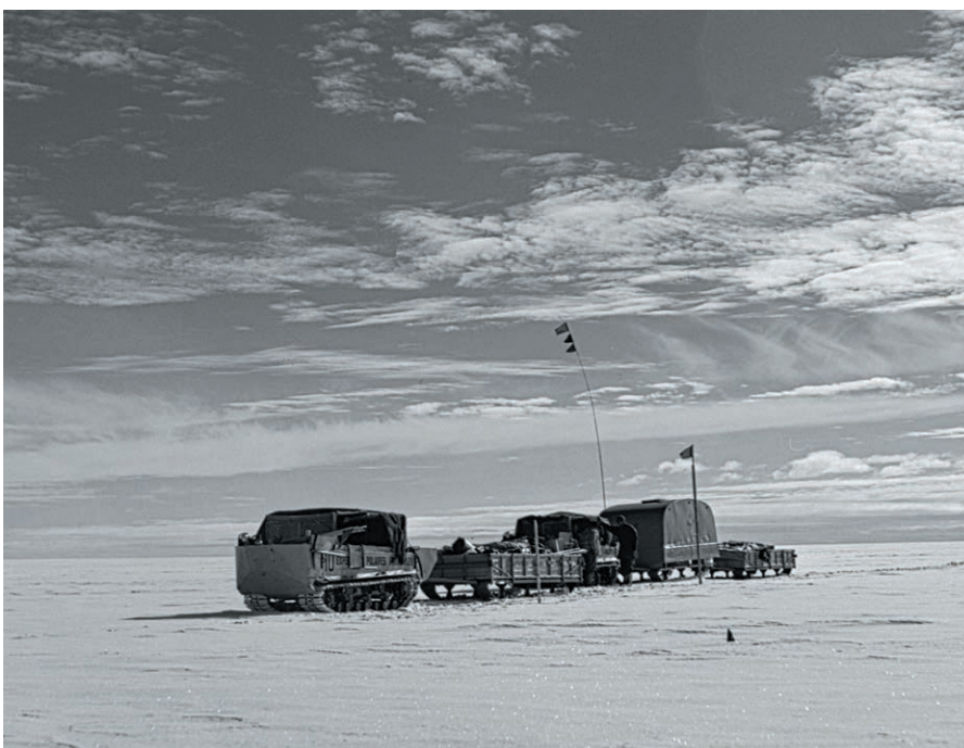
Photo 4. Le convoi de la section de géodésie à proximité d'une balise, à presque 3 000 m d'altitude, le 1 er juillet. Un weasel remorque un traîneau, l'autre (équipé d'une antenne-fouet) remorque la cabine-laboratoire et un traîneau.
