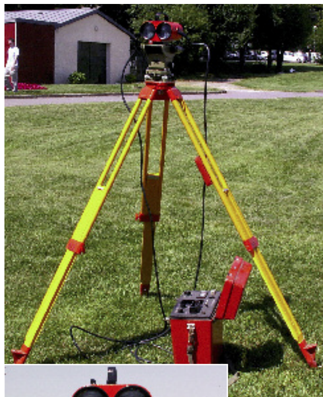
Le distancemètre DI 10. Utilisable seul ou sur la lunette d'un T2 (voir infra dans le paragraphe L'association au théodolite). Avec ses deux optiques
