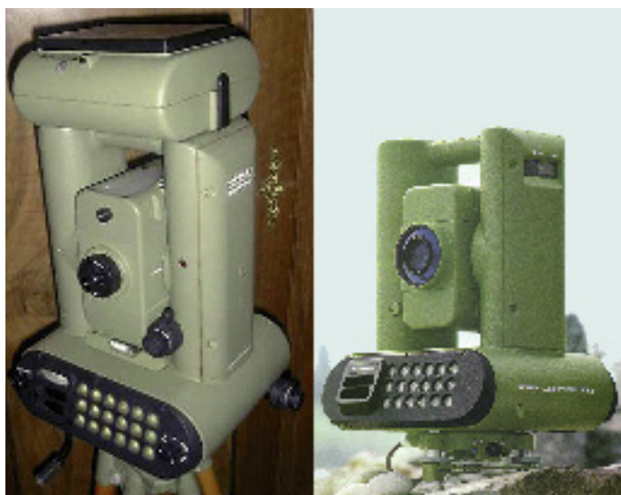
Wild TC1, théodolite électronique de la nouvelle génération avec deux versions : une avec enregistrement des mesures sur coffret extérieur et l'autre avec notation manuelle.
