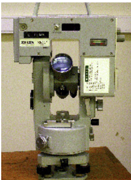
Le Zeiss SM4, petit tachéomètre qui comme le SM11, mesure les distances électroniquement et les angles optiquement. De la génération suivante, sa taille a diminué et l'affichage de la distance se fait par LED.
