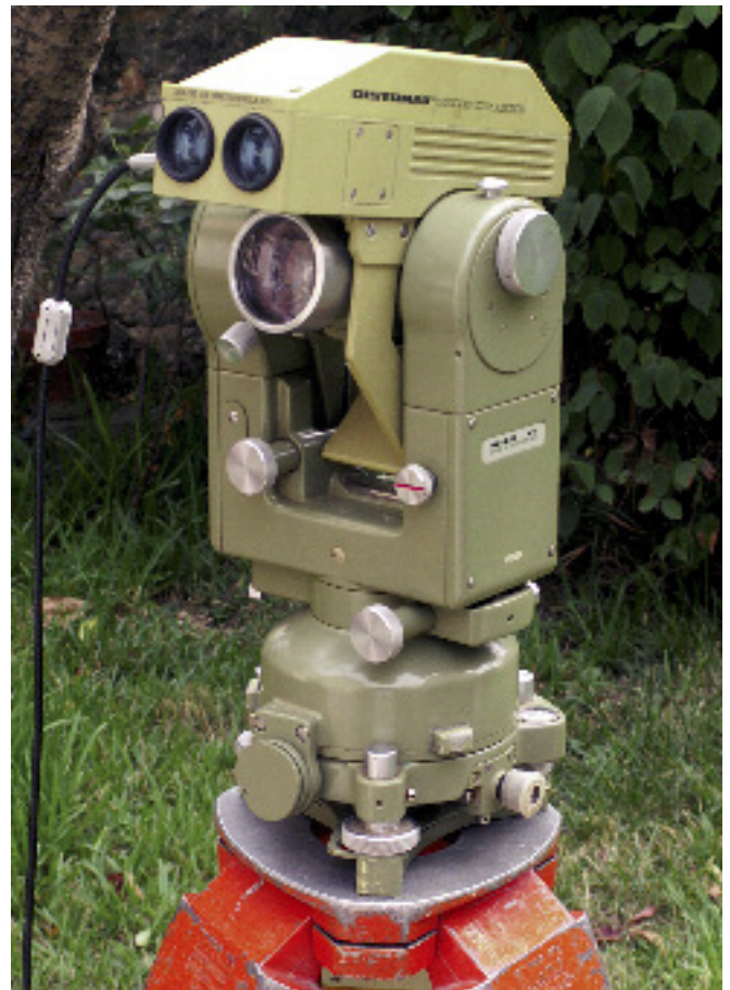
Le DI 1000 distancemètre beaucoup plus compact des générations suivantes. Il n'y a plus de coffret électronique, la miniaturisation électronique et informatique a tout réduit dans un volume restreint. Un câble permettait d'enregistrer la mesure.
