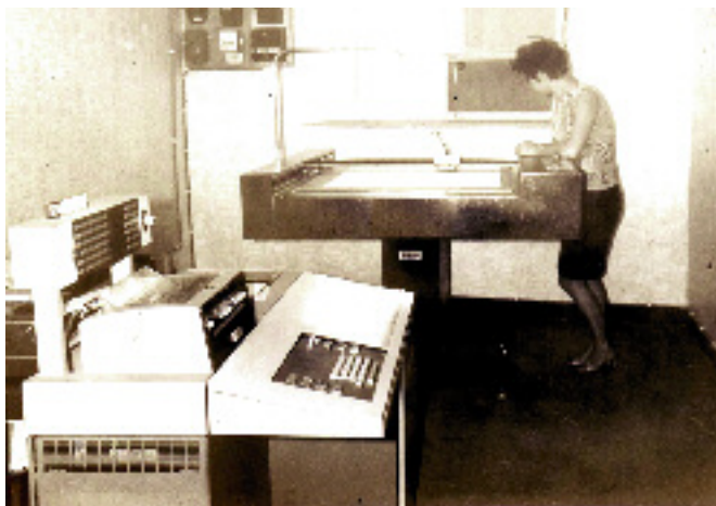
La table traçante Benson 00 associée à un ordinateur IBM 1130. Remarquez la taille de l'ordinateur d'une capacité de 8 Ko ! Pas encore d'écran.
