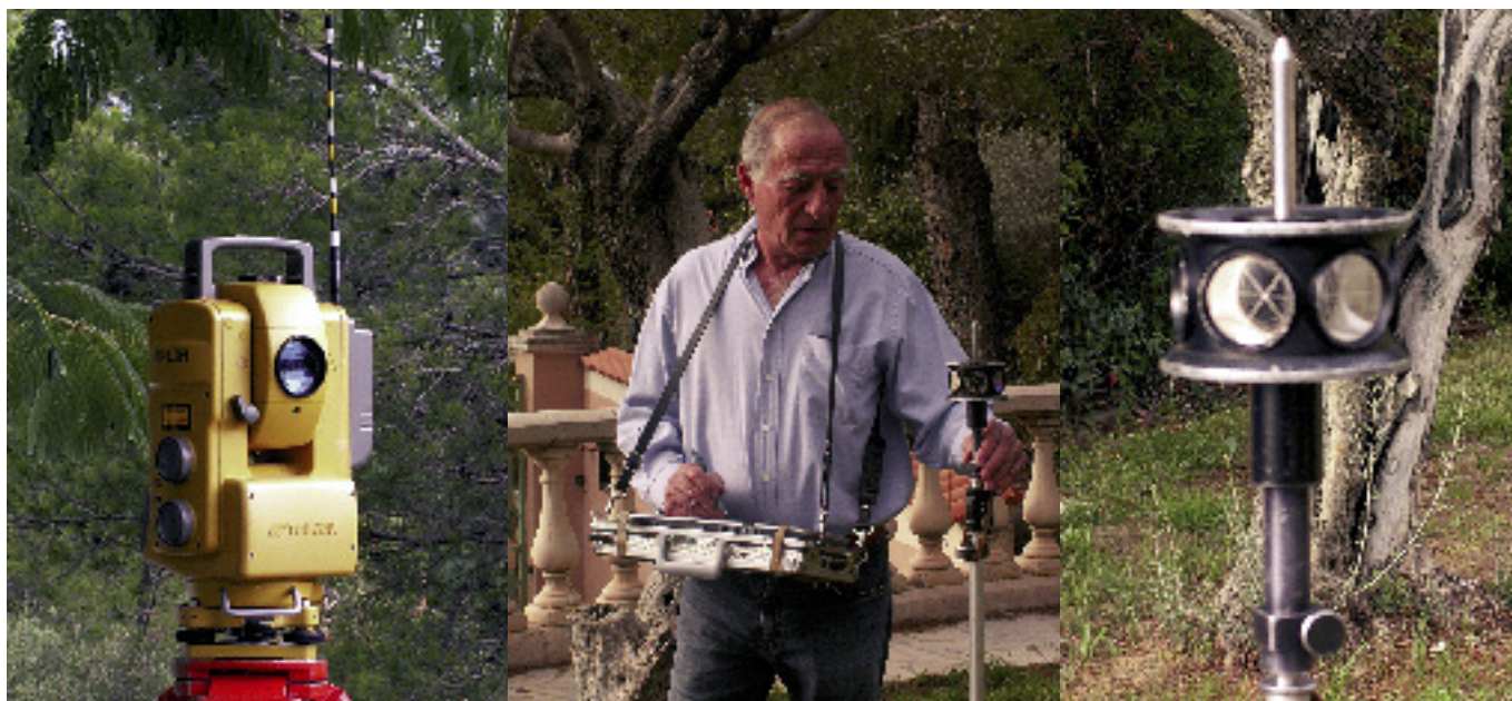
Station robotisée Topcon AP-L1A de 1999. L'antenne permet la liaison radio avec l'opérateur qui tient le prisme. Ici, il n'y a pas de clavier associé au prisme, mais un ordinateur portable sur lequel l'opérateur peut commander la station et faire le dessin en DAO au fur et à mesure du lever. Quant à la canne, elle porte six prismes, ce qui évite à l'opérateur occupé à son lever d'avoir à l'orienter.
