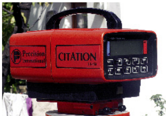
Le Citation, appareil de fin de série, montable sur la lunette d'un théodolite. Je l'avais acheté en 1982 pour une mission en Arabie, alors que j'étais free-lance.
