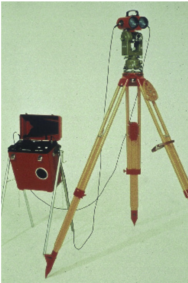
Le DI 10 monté sur un T2. C'est la première association "distancemètre-théodolite".
