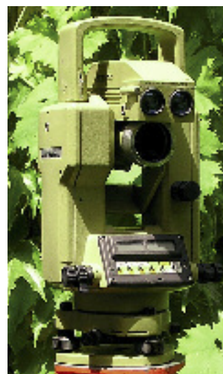
Wild TC1, théodolite électronique de la nouvelle génération avec deux versions : une avec enregistrement des mesures sur coffret extérieur et l'autre avec notation manuelle.
