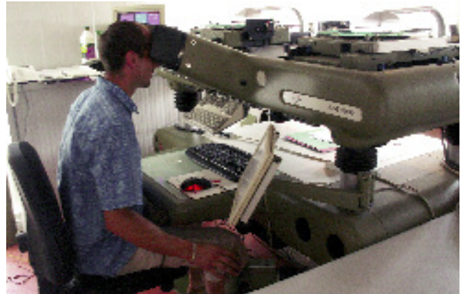
L'AM 2000 est un appareil hybride, qui se rapproche de l'analytique par les deux encodeurs dont on voit le boîtier noir sur les deux chariots portant les clichés. Sur la droite, l'écran qui permet la mise en place des couples, puis le dessin en DAO de la restitution.
