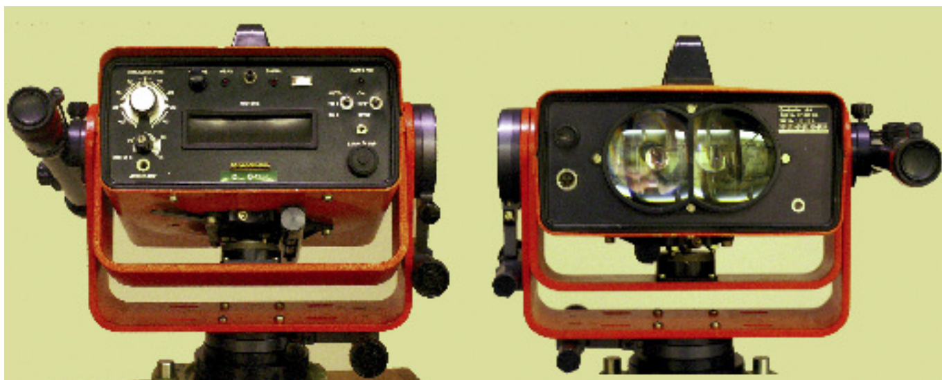
le Geodimeter 14A, produit dans les années 1970 non adaptable à un théodolite. Le volume reste important et il y a toujours deux optiques non coaxiales pour l'émission et la réception du rayon IR. Les distances sont affichées sur LED.
