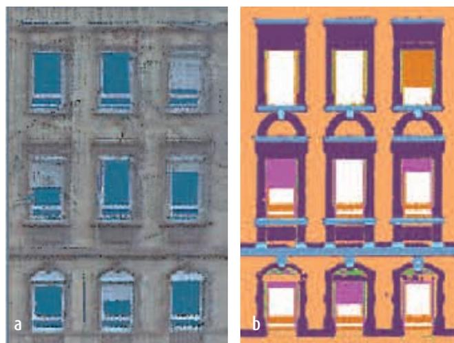
Figure 14. Segmentation d'une façade (Strasbourg) ; a) nuage de points initial, colorisé ; b) éléments plans extraits (Boulaassal et al., 2011a)
