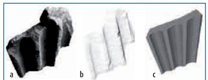
Figure 16. Exemple de modélisation géométrique : a) Photographie ; b) Nuage de points ; c) Modèle géométrique (Begrliche, 2003).
