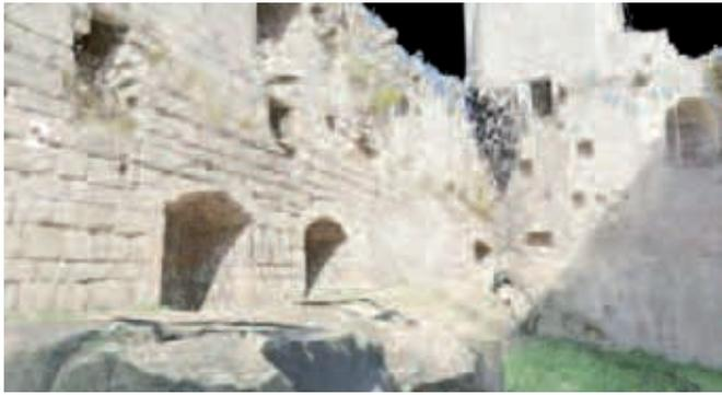
Figure 10. Nuage de points colorisé du Château d'Andlau (Alsace). Partenariat INSA/Imag'Ing - vidéo sur [www.imag-ing.com](http://www.imag-ing.com)
