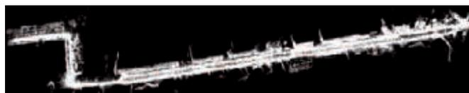
Figure 26. Vue de dessus d'un nuage de points issu d'un relevé mobile sur 1,5 km avec système Optech LYNX Mobile Mapper (bd de la victoire, Strasbourg) ; 280 points/m<sup>2</sup> soit 1 point/10 cm (Boulaassal et al., 2011c).
