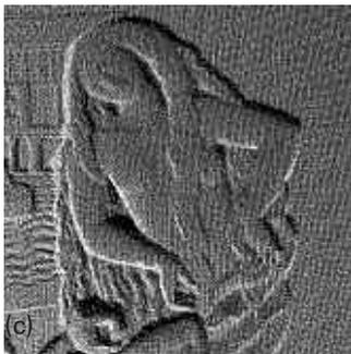
**Figure 5.** Effet du choix du pas de balayage sur le niveau de détail représenté (nuage de points seul) :
