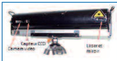
**Figure 12.** Scanner laser Soisic de Mensi (Trimble) utilisant la triangulation pour déterminer la distance.
