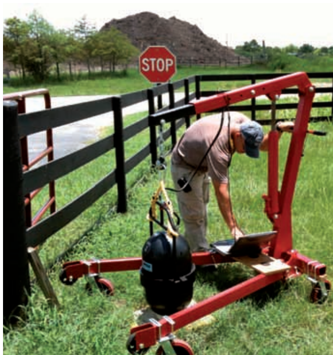
Figure 12. Test d'un Gipsea 3000 sur ligne de base de 123 m, photo de l'auteur.
