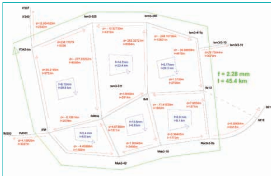
Figure 6. Schéma des cheminements de nivellement avec longueurs (l), dénivelée (d) des tronçons et fermetures (f) des mailles formées.
