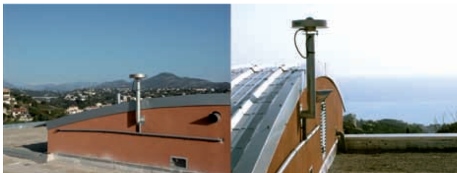
Figure 7. NICA, la station permanente GPS de la Communauté urbaine Nice Côte d'Azur, intégrée au RGP.
