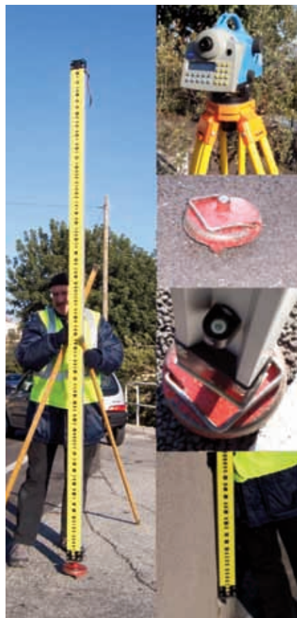
Figure 4. Matériel topographique utilisé lors des opérations de nivellement (Porte-mire : M. Guy Demirdjian)
