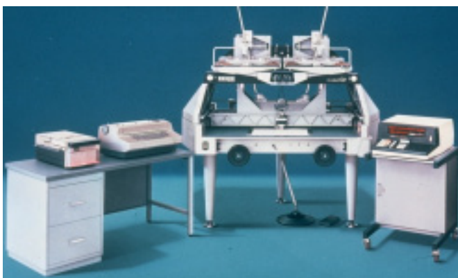
Un planimat D2 modernisé des années 1970 : le restituteur est toujours le même, mais, il n'y a plus de table traçante. Les coordonnées et codes de chaque pointé sont enregistrés.
