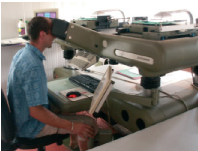
L'AM 2000 est un appareil hybride, qui se rapproche de l'analytique par les deux encodeurs dont on voit le boîtier noir sur les deux chariots portant les clichés. Sur la droite, l'écran qui permet la mise en place des couples, puis le dessin en DAO de la restitution.
