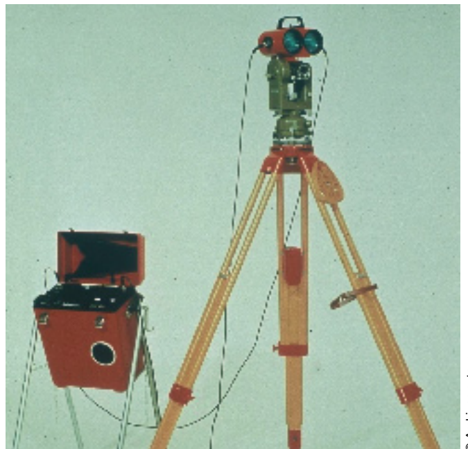
En 1968, début de l'association théodolite-distancemètre : un DI 8 monté sur un T2. On voit au sol l'imposant coffret où sont traités les signaux et effectués les calculs.
