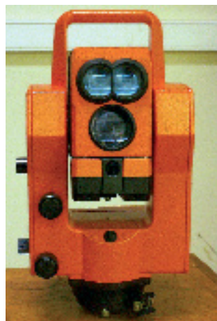
Le Geodimeter 422 du début des années 1980. Le distancemètre n'est pas coaxial et comporte encore deux optiques séparées.
