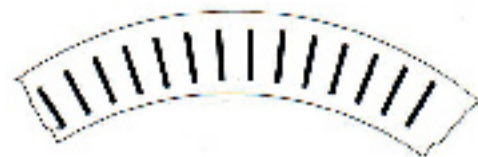
Codage incrémenté des graduations.
