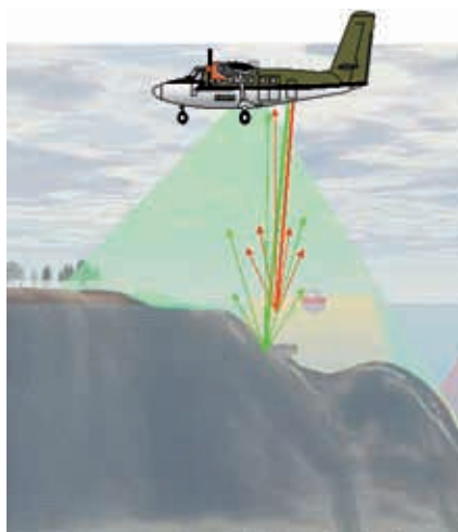
Figure 9. Principe du laser bathymétrique aéroporté.
